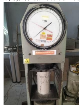
Gambar 1. Pengujian Kuat Tekan Beton
