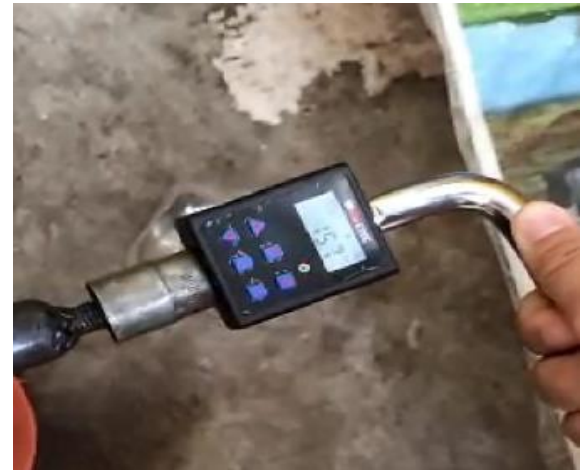
Gambar 13. Pengukuran Torsi Menggunakan Digital Torque Meter
