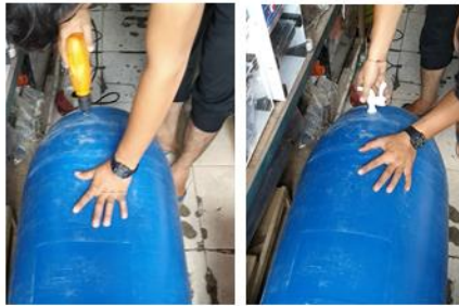
Gambar 9. Proses melubangi dan memasang kran
