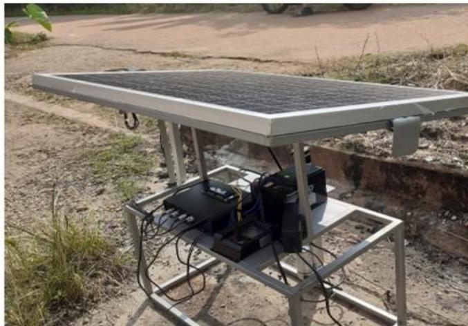
**Gambar 8** Hasil desain mekanik *solar tracker* satu sumbu
