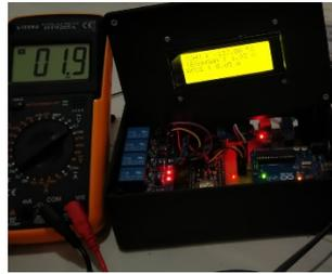
**Gambar 8.** Pengukuran Sensor Tegangan dan Multimeter
