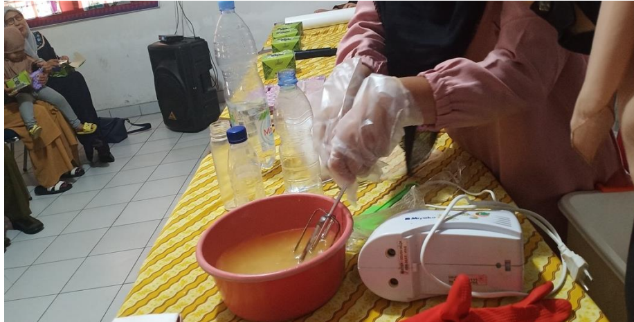
Gambar 4. Proses Pengadukan Bahan Pembuatan Bahan Sabun Transparan Berbahan Minyak Kelapa Murni (VCO)
