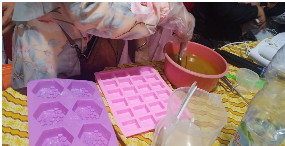
Gambar 5. Proses Pencetakan Bahan Pembuatan Bahan Sabun Transparan Berbahan Minyak Kelapa Murni (VCO)
