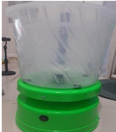
Gambar 3. Bagian Tabung luar yang disebut Body Spinner
