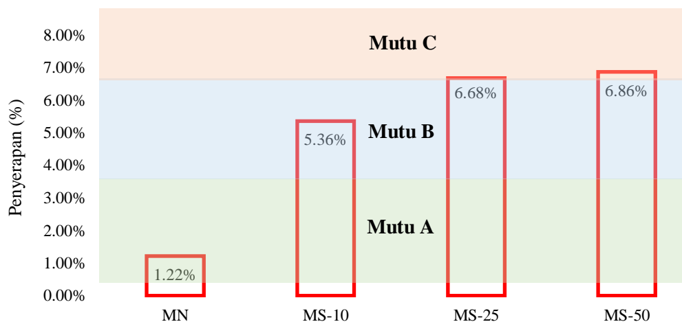
Gambar 8. Mutu paving block berdasarkan tingkat penyerapan
