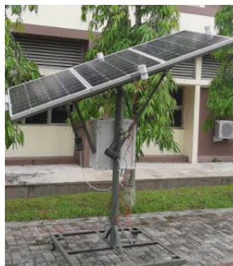
Gambar 8. Pengujian sistem solar tracker pada jam 09.30 WIB dengan kemiringan sudut vertical 69^\circ
