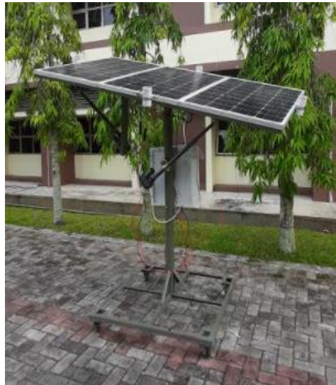
Gambar 10. Pengujian sistem solar tracker pada jam 14:00 WIB dengan kemiringan sudut vertical 115^\circ
