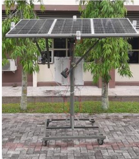
Gambar 9. Pengujian sistem solar tracker pada jam 12.00 WIB dengan kemiringan sudut vertical 90^\circ
